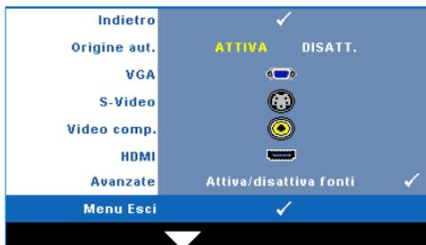
**ORIGINE AUT.**—Selezionare **Disatt.** (opzione predefinita) per bloccare il segnale di ingresso corrente. Se si preme il tasto **Sorgente** quando si imposta la modalità **Origine aut.** su **Disatt.**, è possibile selezionare manualmente il segnale di ingresso. Selezionare **Attiva** per rilevare automaticamente i segnali di ingresso disponibili. Se viene premuto il tasto **Sorgente**
